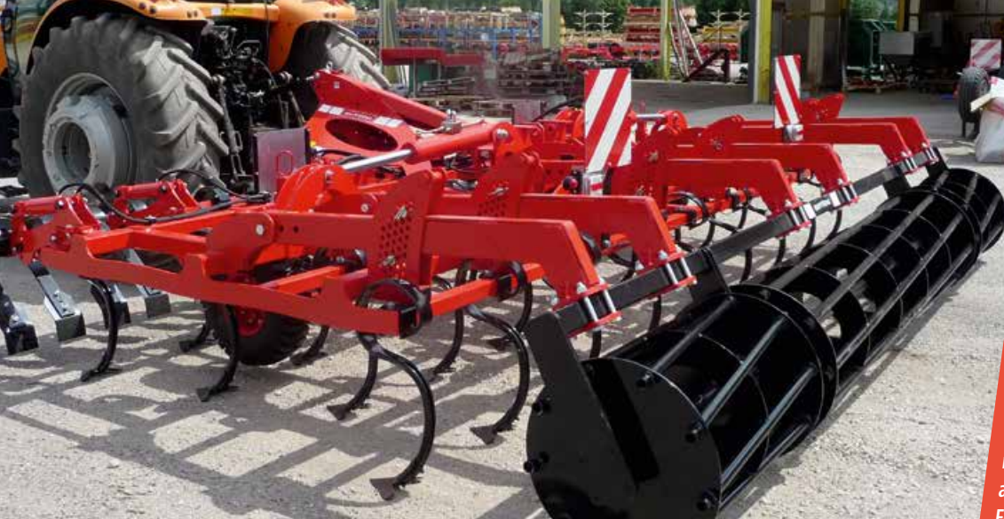
Szállítási helyzet Z-lezáró hengerrel
