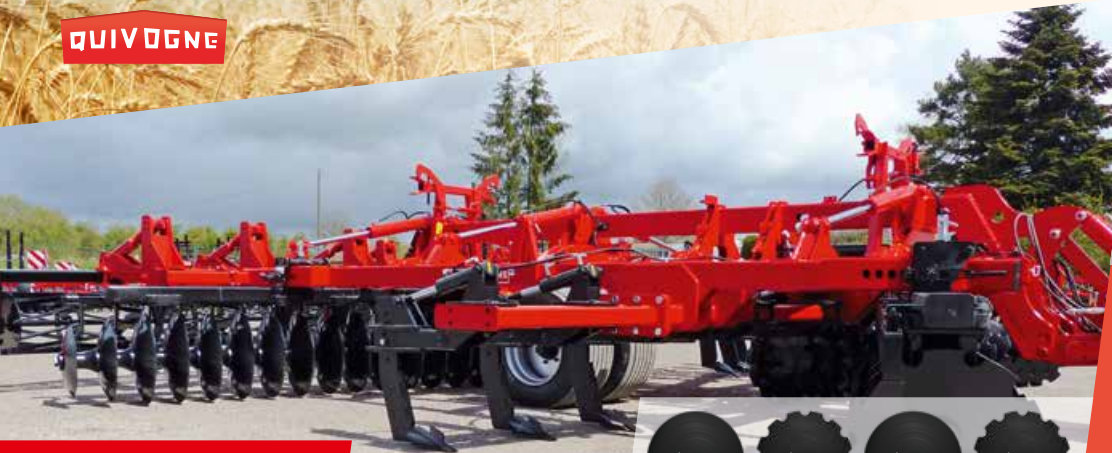
Állítható mélységű lazítók szárnyas késsel és Non-Stop biztosítással
