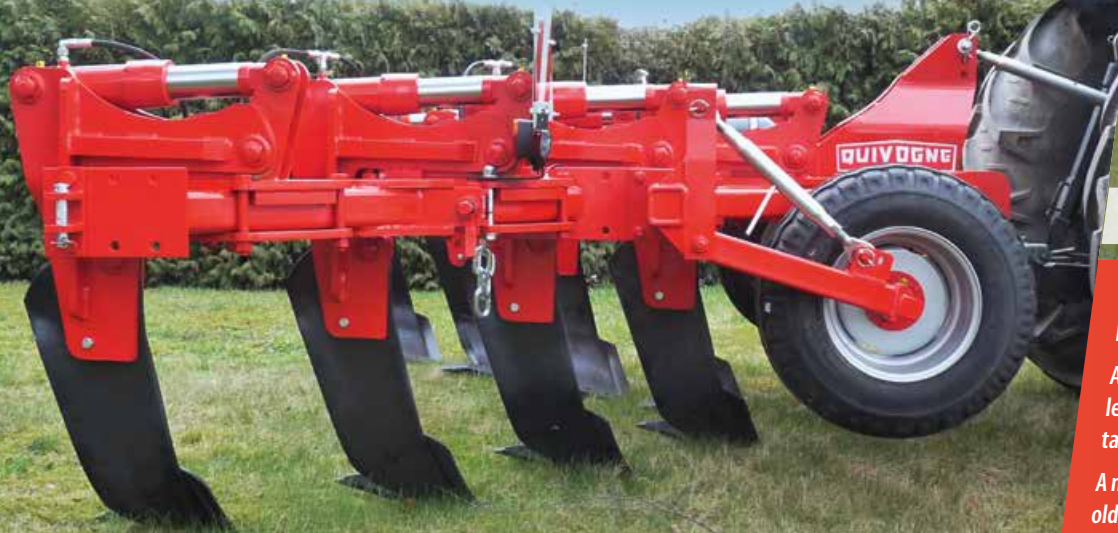
SSD Non-Stop hidraulikus késbiztosítással
